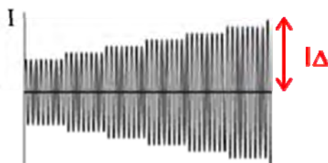
Obr. 6 – Měření vybavovacího proudu RCD – průběh měřicího proudu
