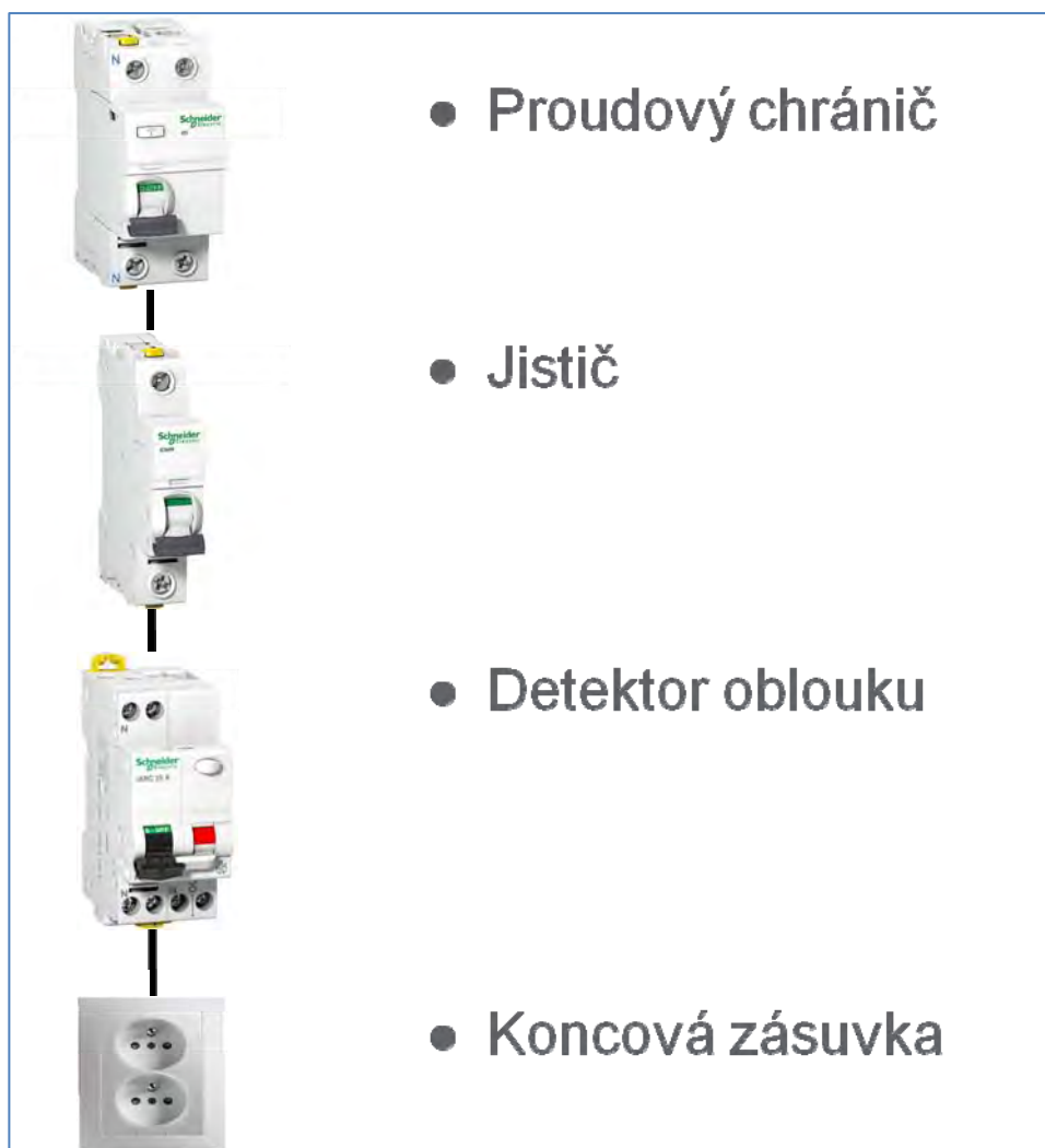
Obrázek 4, zapojení AFDD v obvodu zásuvky
