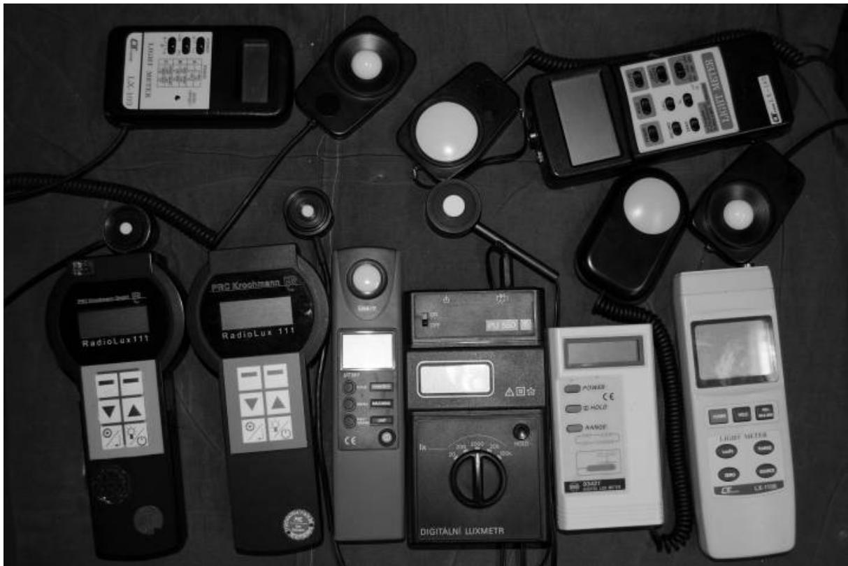
Obr. 6 Použité luxmetre s rôznou smerovou chybou f_2
