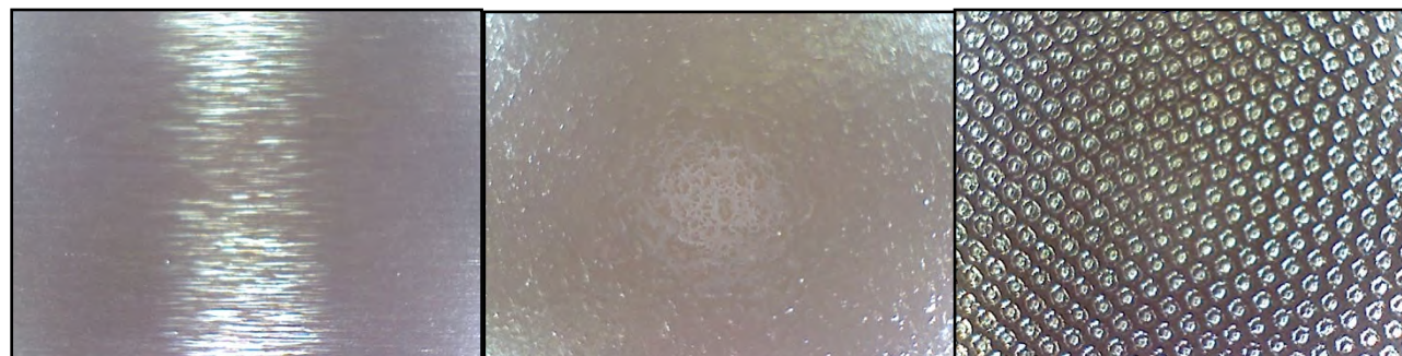
Obr. 12 Rozne druhy hliníkových plechov. Zľava: Alanod Miro 5, Alanod Miro 20, Alanod Miro 85
