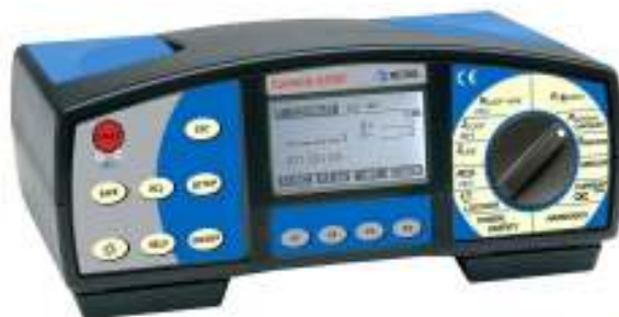
Obr. 8 – Eurotest 61557 s funkcí měření napětí mA bodu
