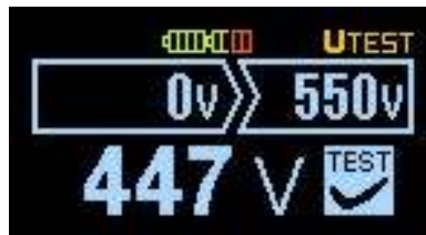
Obr. 12 – Výsledok měření s vyhodnocením testu SPD
